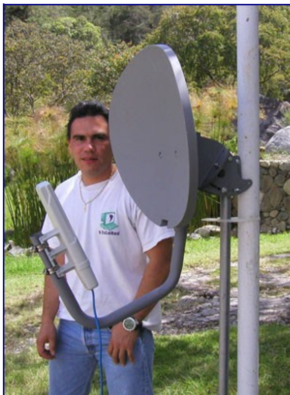
Figura 10: Enrutador inalámbrico Motorola Canopy con reflector parabólico para aumentar la ganancia.
